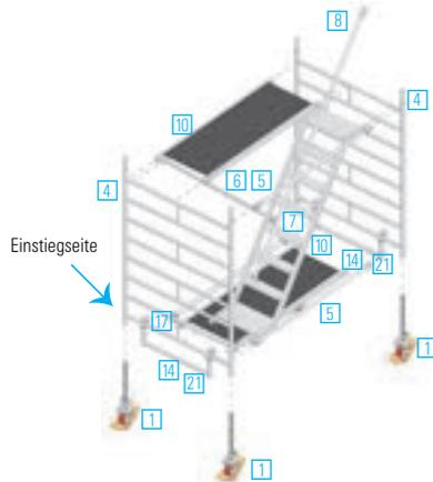
Lenkrollen 1 in die Standleitern 4 einstecken und durch Festdrehen der Flügelschrauben an den Spindelmuttern gegen Herausfallen sichern.
