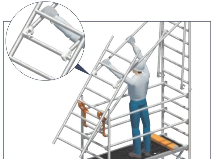
13. Mit Hilfe des Stirnbretts 33 oder einem zusätzlich zur Verfügung stehenden Geländer, welches jeweils als Verlängerung dient, wird der Schließbügel der Einrastklauen von einem der noch montierten Zwischengeländer bzw. Geländer 19 in ca. 2,5 m Höhe gelöst und die Einrastklaue damit einseitig ausgehoben. Im Anschluss kann das einseitig gelöste Geländer 19 nun auf der in den Uni Montagehaken 31 positionierten Seite gelöst und durch eine Drehung in eigener Achse um 90° demontiert werden.
