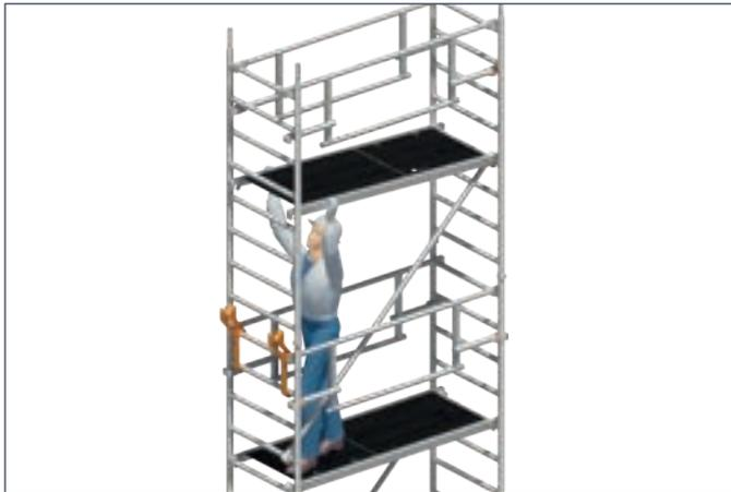
4. Die zweite Diagonalen **24** und die Durchstiegsbrücke **30** einsetzen.
