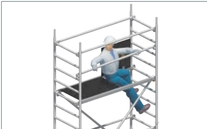
5. Innenseitiger Aufstieg über die Sprossen der Standleiter durch die dafür vorgesehene Durchstiegsklappe. In der Durchstiegsöffnung sitzend, absturzesichert durch die Holme der Durchstiegsbrücke **30**, erfolgt die Montage des Zwischengländers der nächsten Lage. Hierzu werden die Geländer **19** an den zweiten Sprossen über der Standfläche montiert.
