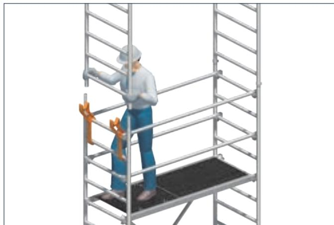
3. Durchstiegsbrücke **30** und Diagonalen **24** demontieren.
