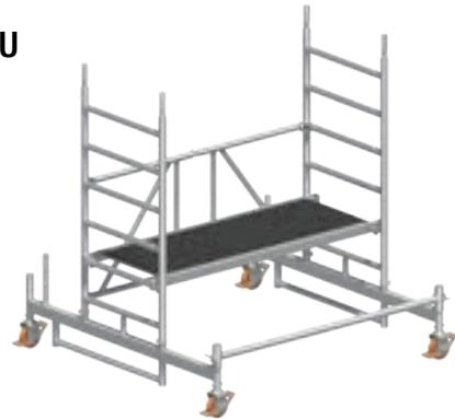
1. Die Lenkrollen **1** in die Fahrbalken **8/9** einstecken und mit den zugehörigen Schrauben und Muttern gegen Herausfallen sichern.
