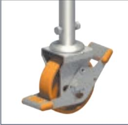
Die Lenkrollen sind im Aufbau und Arbeitszustand durch Drücken des mit Stop gekennzeichneten Bremshebels festzustellen. In gebremstem Zustand muss der mit Stop gekennzeichnete Hebel unten sein. Zum Verschieben werden die Rollen durch Drücken des gegenüberliegenden Hebels gelöst.
