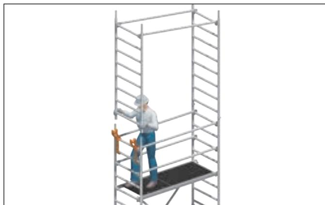
3. Standleiter **75/8 17** mit Geländern **19** nach oben schwenken, aufstecken und mit Federsteckern **18** sichern.
