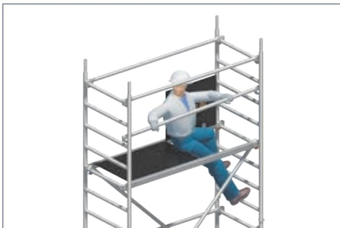
2. In der Durchstiegöffnung sitzend, absturzgesichert durch die Holme der Durchstiegsbrücke **30**, erfolgt die Demontage der Zwischen Geländer der jeweiligen Lage. Hierzu werden die Geländer **19** an den zweiten Sprossen über der Standfläche demontiert. Sollten die Einrastklauen der Geländer **19** aus der sitzenden Position in der Durchstiegöffnung nicht erreichbar sein, erfolgt die Demontage wie unter **8**. beschrieben.
