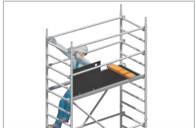
8. In der Durchstiegöffnung sitzend, absturzgesichert durch die Holme der Durchstiegsbrücke 30, erfolgt das einseitige Lösen und Auflegen der Einrastklauen von beiden Geländerholmen auf der Seite der Durchstiegsklappe in 1 m Höhe über der Standfläche.
