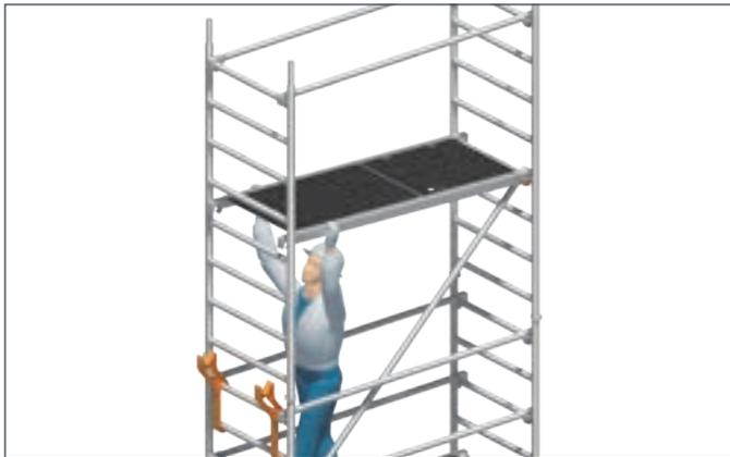
4. Diagonalen **24** und Durchstiegsbrücke **30** einsetzen.
