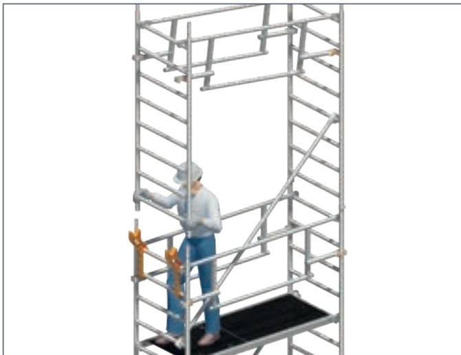
5. Die Standleiter 75/8 **17** auf der Seite der Uni Montagehaken ausheben und mitsamt der beiden Sicherheits-Doppelgeländer **21** nach unten schwenken und in den Uni Montagehaken **31** positionieren.
