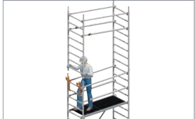
3. Die zweite Standleiter 75/8 **17** mitsamt dem vormontierten Seitenschutz nach oben schwenken, aufstecken und mit Federsteckern **18** sichern.
