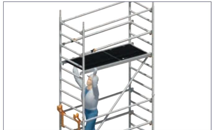
4. Beide Diagonalen **24** und die Durchstiegsbrücke **30** einsetzen.
