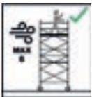
Bei Verwendung im Freien oder in offenen Gebäuden sind **Arbeiten auf der Fahrbaren Arbeitsbühne bei Windstärken über 6 nach Beaufort-Skala sofort einzustellen**. Die Fahrbaren Arbeitsbühnen sind bei genannten Windgeschwindigkeiten oder bei Schichtschluss in einen windgeschützten Bereich zu verfahren oder durch andere geeignete Maßnahmen gegen Umkippen zu sichern.
