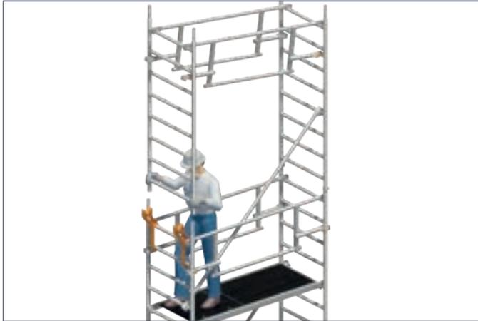
3. Die Standleiter 75/8 **17** aus der Position in den Uni Montagehaken **31** nach oben schwenken, aufstecken und mit Federsteckern **18** sichern.
