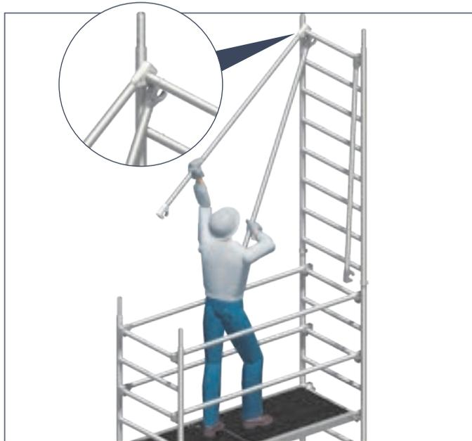
7. Demontage der Geländer 19 durch öffnen der Einrastklaue mithilfe von einem der unter 2. demontierten Zwischengeländer. Das lose Geländer 19 wird auf die 2. Sprosse von oben aufgelegt und wirkt als Hebel zum Öffnen des Schließbügels der Einrastklaue (siehe Detail).
