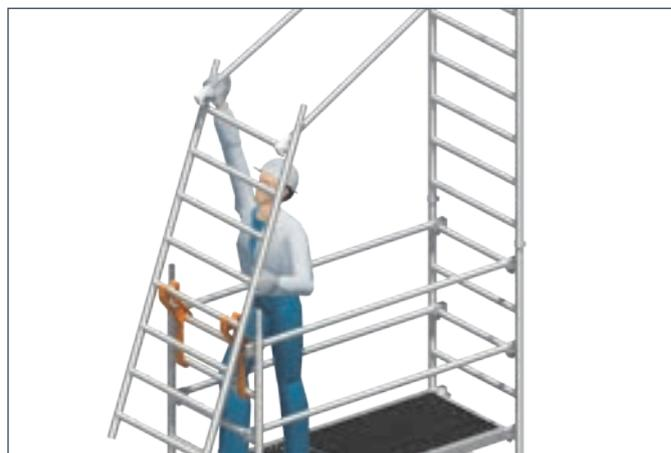
6. Einseitiges Aushängen der Geländer 19 aus der positionierten Standleiter.
