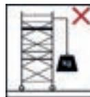
Das Anheben von schweren Gegenständen durch das Anbringen und die Verwendung von Hebezeugen an Fahrbaren Arbeitsbühnen ist nicht gestattet.
