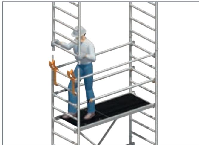
5. Standleiter 75/8 **17** auf der Seite der Uni Montagehaken ausheben, mitsamt des noch montierten Seitenschutzes nach unten schwenken und in den Uni Montagehaken **31** positionieren.
