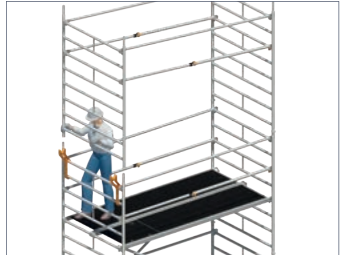
2. Standleiter mit den Geländern und Uni Telegeländern nach oben schwenken und auf unterer Standleiter aufstecken.
