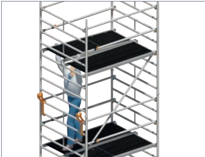
3. Diagonalen, Belagbrücke und Durchstiegsbrücke einsetzen.
