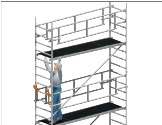
3. Diagonalen und Durchstiegsbrücke einsetzen.
