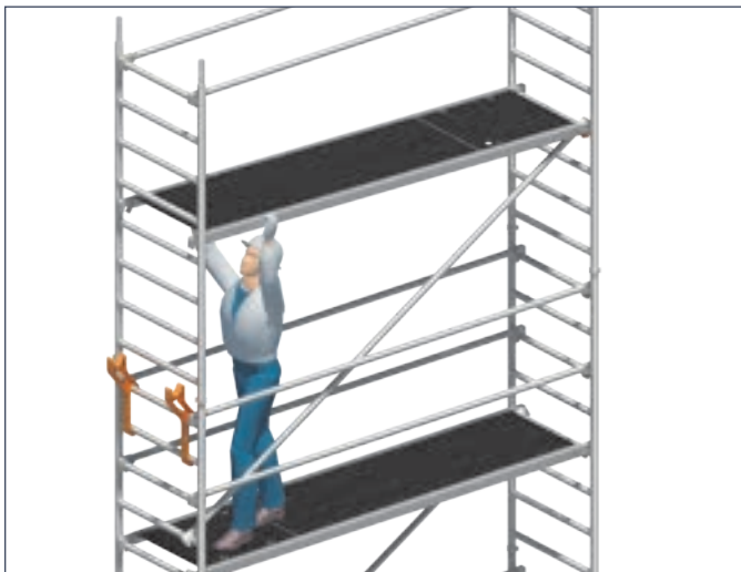
3. Diagonalen und Durchstiegsbrücke einsetzen.
