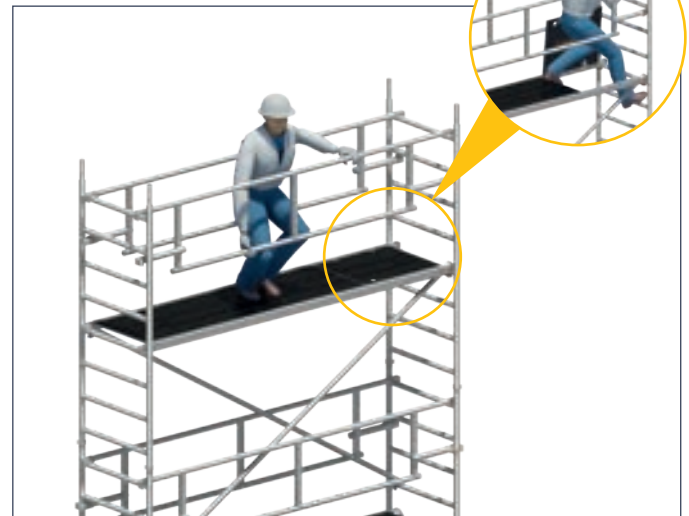
4. Aufstieg in die bereits gesicherte Lage und finales Einrasten des Doppelgeländers (untere Einrastklauen) in die Standleiter.
