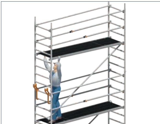
3. Diagonalen und Durchstiegsbrücke einsetzen.
