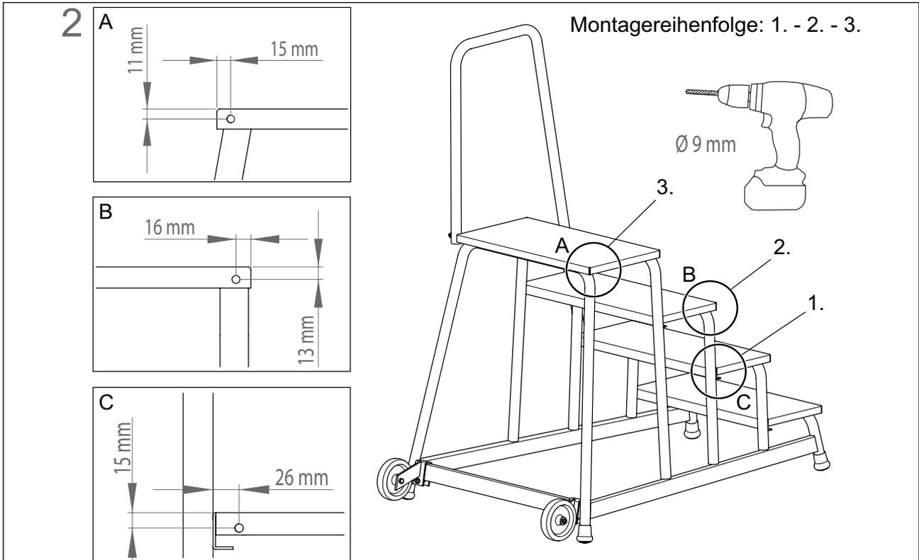
Handlauf links spiegelgleich wie Handlauf rechts montieren.
